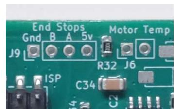
GND est le fil commun aux deux interrupteurs. Mettre en contact le fil A ou le fil B avec GND, empêche tout mouvement du moteur dans la direction correspondante.
