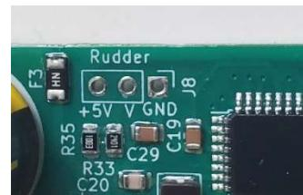
Si on raccorde un capteur de barre existant avec seulement deux fils, une résistance de 1kΩ doit alors être ajoutée entre la broche 5 V et la broche mesure.
